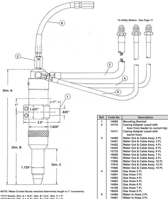
11118 Nozzle: Dim. A = 11.5", Dim. B = 7.5", Dim. C = 4" 11119 Nozzle: Dim. A = 12.5", Dim. B = 8.5", Dim. C = 5"
